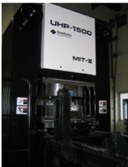
川井式2段アンビル型超高压発生装置
