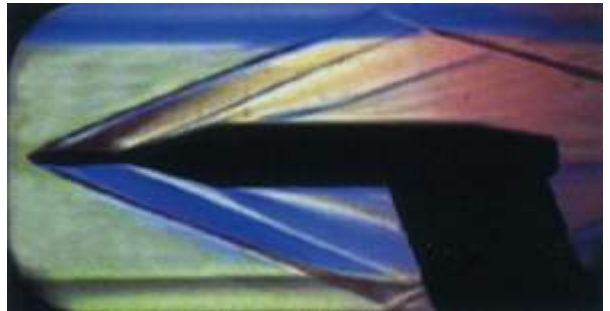
マッハ4で飛行する楔周辺の衝撃波の可視化
